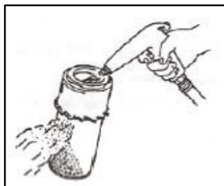
Figura 2 9 Limpieza filtro de aire
